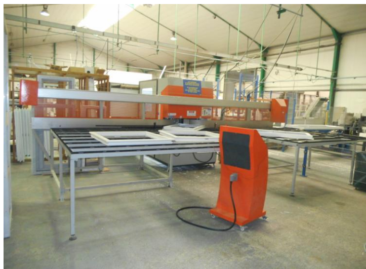
Ebavureuse automatique d'angles ELUMATEC EV884
