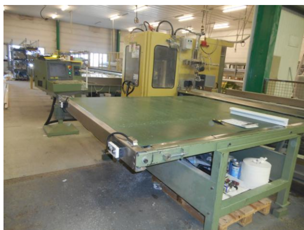
Centre d'usinage à commande numérique SOENEN HENDRIK Table de travail - 7 x 2 m env. Tapis convoyeur motorisé - 3 x 3 m env. Avec convoyeur incliné de 2,5 m
