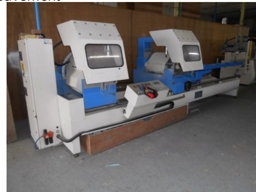
Scie automatique MECAL SW453 VICO REVERSE Double lames à angle de coupe réglable Longueur : 4,5 m An. 2000
