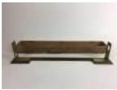
Alidade à niveau ou niveau d'arpenteur en bois et laiton, les illets rétractables.
